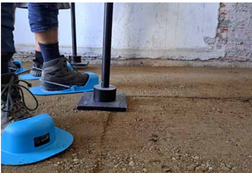
Abb. Reihe 3 verdichteter Schaumglasschotter und Stampflehm Mischung im Big Pack vorm Haus
